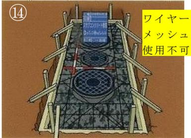
14 上部スラブコンクリート 型枠、配筋 鉄筋 D=△△ @=△△△
