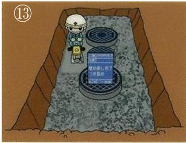
13 埋め戻し完了、つき固め
