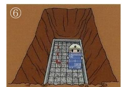
6 基礎コンクリート 型枠、配筋状況 鉄筋 D=△△ @=△△△
