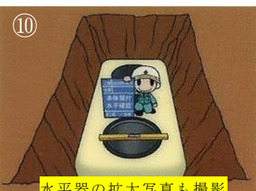
⑩ 本体据付、水平確認
