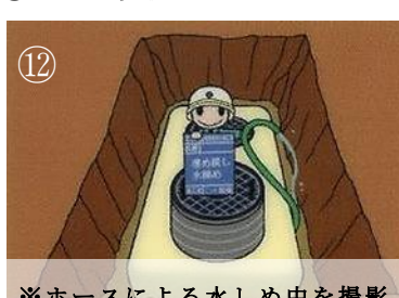
⑫ 埋め戻し、水じめ ※ホースによる水しめ中を撮影
