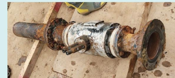
経年劣化により腐食が進んだ水道管
