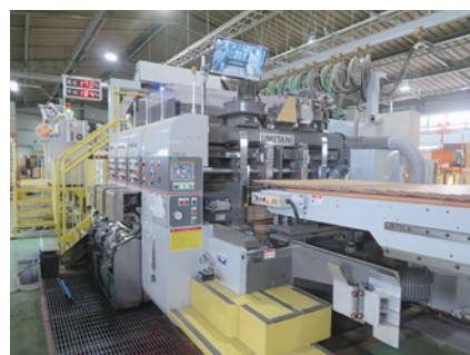
段ボールを製造する機械
