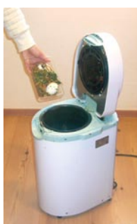
▲電動生ごみ処理機
